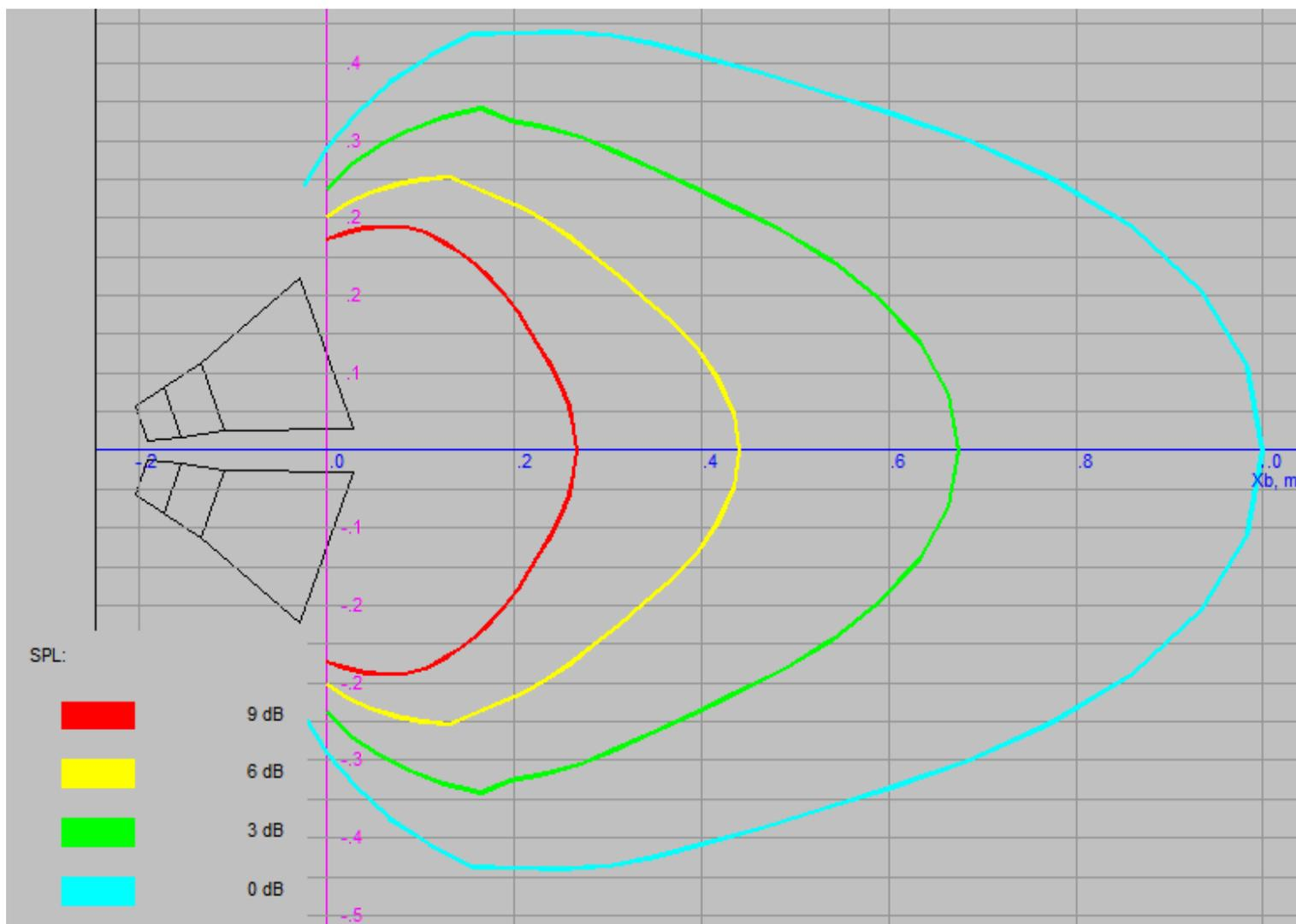
*Ci-dessus nous visualisons les courbes isobares à 1000 hz de 2 horns CS-12 VCT dans le plan vertical dont les bords sont coïncidents à - 6 dB.*
